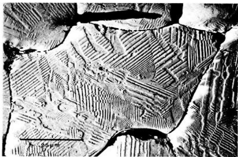
BaTiO_3 中的电畴结构
